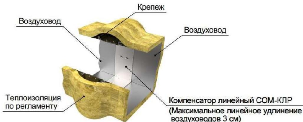
В ходе монтажа воздуховода дымоудаления с линейным компенсатором СОМ-КЛР необходимо не допускать крепления частей линейного компенсатора к несущим конструкциям здания.
